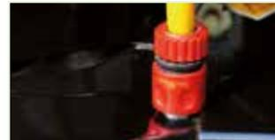
Schlauchanschluss für einfache Reinigung der Mähdeckunterseite mithilfe von Waschdüsen.
