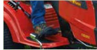
Mit dem hydrostatischen Getriebe können Sie die Geschwindigkeit kontinuierlich steuern, ohne Kupplung oder Gangwechsel.
