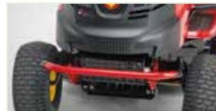
Frontstoßstange für Kollisionsschutz.
