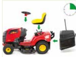
Alle WOLF-Garten Traktoren sind »Ready to use«, also in wenigen Minuten betriebsbereit. Lenkrad und Sitz lassen sich mit dem beigelegten Werkzeug mit drei Schrauben montieren. Der Grasfangsack wird werkzeuglos zusammengesteckt.
