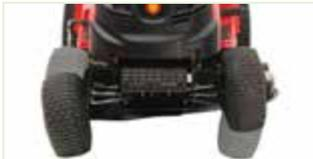
Pendelnd aufgehängte Vorderachse für einen gleichmäßigen Schnitt auch bei Bodenunebenheiten.
