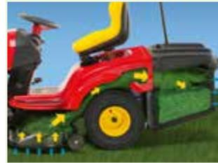
Bei Rasentraktoren mit Heckauswurf wird das Schnittgut über einen zentralen Auswurfkanal auf kürzestem Wege in den Fangkorb geführt. So gewährleisten sie einen optimierten Schnittgut-Transport und ein perfektes Füllen.
