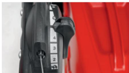
Mit dem Vario-Antrieb kann die Geschwindigkeit stufenlos geregelt werden von ca. 2.8 - 4.5 km/h
