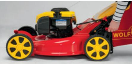
**2-Hebel-Achsverstellung für ein einfaches Ändern der Schnitthöhe**
