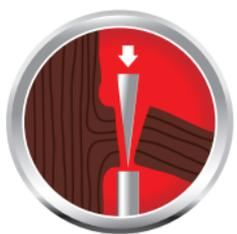
Die Einschneiden- oder Amboss-Technik spart bis zu 20 % Kraft gegenüber der Zweischneiden-Technik. Dabei liegt das Schnittgut auf dem sogenannten „Amboss“ auf. Amboss-Scheren sind ideal für das Schneiden von abgestorbenem und hartem Holz (z. B. beim Rosen- und Strauchschnitt). Sie ermöglichen gelenkschonendes Arbeiten ohne Schnittschlag.
