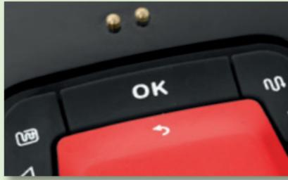
Wird zu nasser Rasen gemäht, verklumpt das Schnittgut, das Mähgehäuse verschmutzt und das Schnittbild leidet. Mit Hilfe des einstellbaren Regensensors können Sie wählen, bis zu welchem Feuchtigkeitsgrad gemäht werden soll. Wird dieser überschritten bleibt der ROBO SCOOTER® in der Ladestation. Sie sparen sich lästige Reinigungsarbeiten und die Rasenfläche bleibt top.
