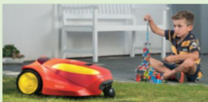
Um Ihre Kinder zu schützen und den Einsatz durch Unbefugte zu verhindern, verfügen die ROBO SCOOTER® über eine elektronische Sicherheitssperre. Werden sie angehoben bzw. gekippt, stoppen die Messer sofort. Treffen sie auf ein Hindernis werden zunächst die Messer und der Mäher angehalten. Danach setzen sie den Mähvorgang in einer anderen Fahrtrichtung fort.
