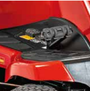
Vorwärts- und Rückwärtsgang per Fußpedal (Hydrostat-Getriebe)
