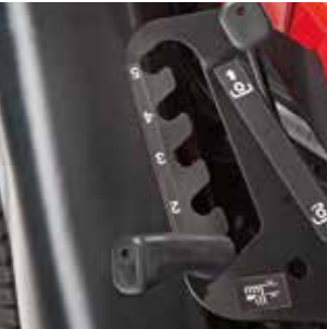
5-fache Schnitthöhenverstellung zwischen 3,8 und 9,5 cm wählbar
