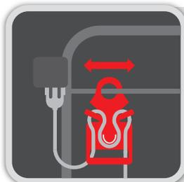
**PATENTIERTE »FLICK FLACK®«-KABELFÜHRUNG:** Das Kabel wird geführt und gegen Zugbelastung geschützt. Es muss nicht mit der Hand festgehalten werden und wird beim Mähen neben dem Gerät abgelegt, um ein Überfahren des Kabels zu verhindern.
