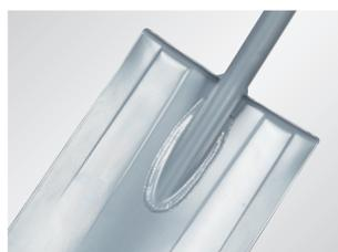
La testa della lama è saldata in acciaio al Boro indurito tramite induzione con nervature di irrigidimento per una maggiore durata.
